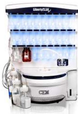
**Liberty Blue** — высокоскоростная система твердофазного синтеза пептидов
